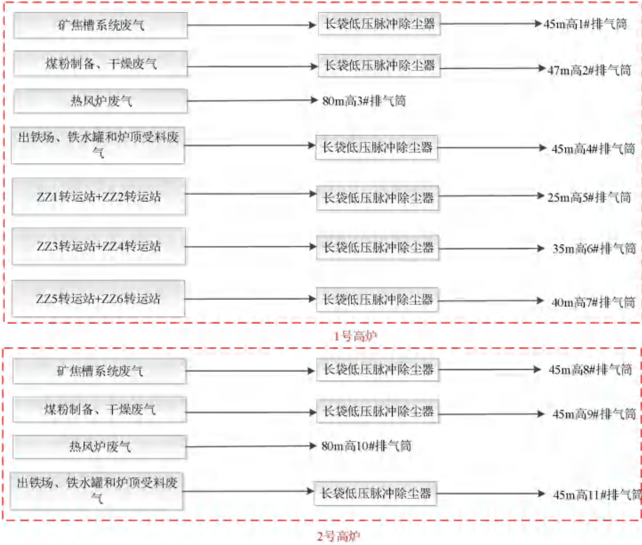
图 8.1-1 本项目废气收集系统流程框图
